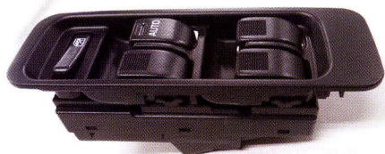
▲これがドアの内側に隠れているパワーウィンドウスイッチの本体
