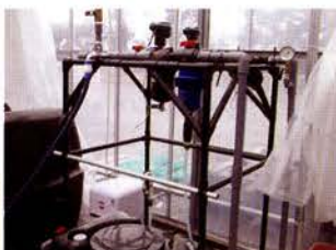
▲ビニールハウス内に設けられた肥料の自動供給機
