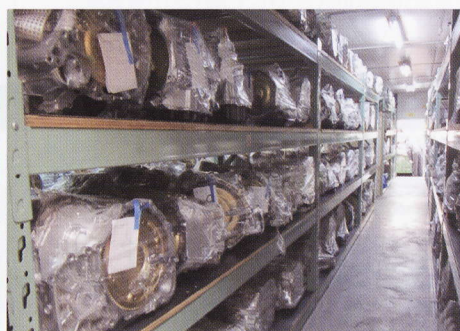
▲組み立てられた再生ミッションは包装されて棚に並べられる
