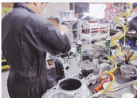
▲重要部品のATミッションを組み立てている
