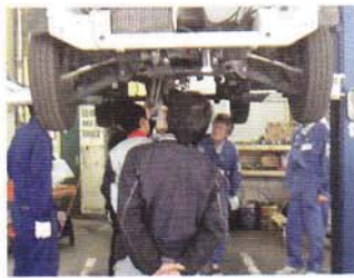
◀リフトアップした車体の下にもぐってモーターの取付具合をチェックしている
