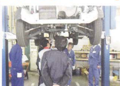
▲組み立てた電気モーターをリフトアップした中古車に装着していく
