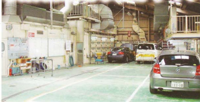
▲車体整備の作業現場はまず塗装用のブースとフレーム修正機をセットする場所が中心となる
